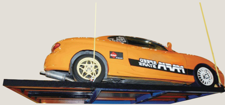
▲ 슈퍼 섬유 강도 측정을 위해 자동차를 들어 올리는 모습
